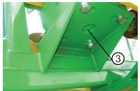
Caja del eje propulsor - Tapón de vaciado
