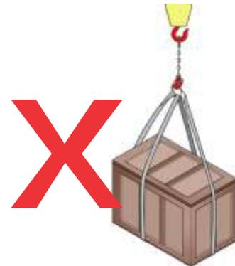
Siempre que sea necesario izar la máquina con ella fuera de la caja, hágalo con los tirantes adecuados, fijando correctamente en los puntos indicados en la figura.
